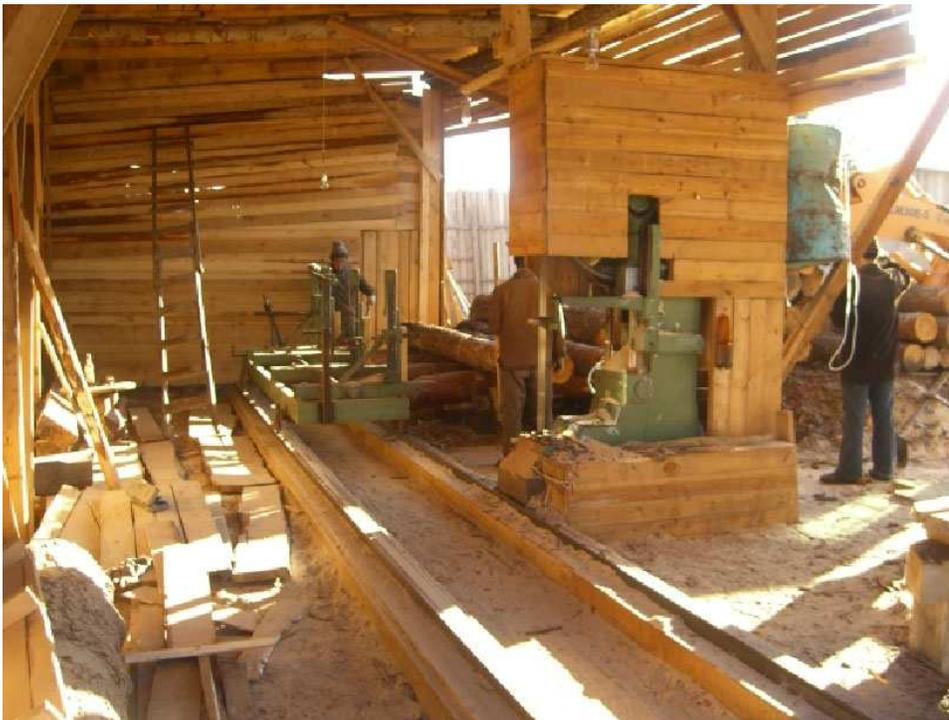
FIGURE 4.2 THE BREAKDOWN SAW AT SAWMILL COMPANY 1, IRKUTSK REGION
