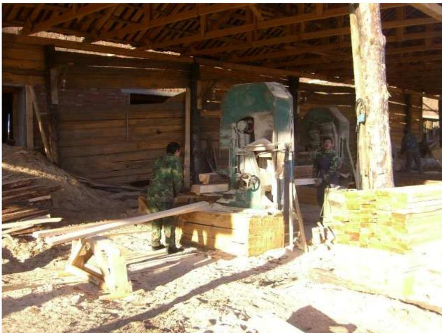
FIGURE 5.2 TYPICAL RESAW BAND SAW AT COMPANY B MILL, IRKUTSK REGION
